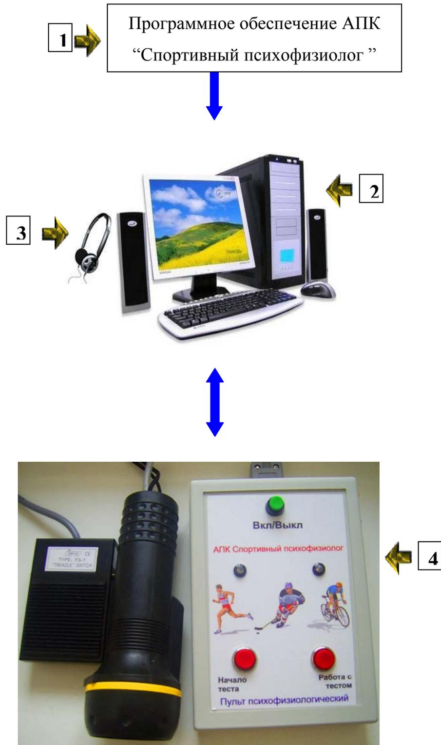
Рис. 1. Блок-схема АПК "Спортивный психофизиолог"
